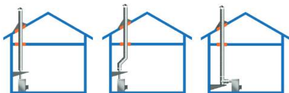
внутренний монтаж дымохода (основные варианты)
