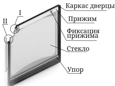
Рисунок 15. Ремонт светопрозрачного экрана дверцы модификации «Витра»
