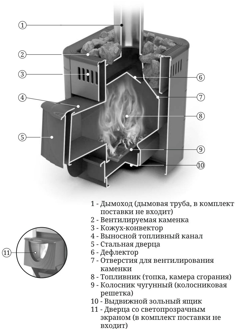
Рисунок 3. Расположение основных элементов печи «Оса»
