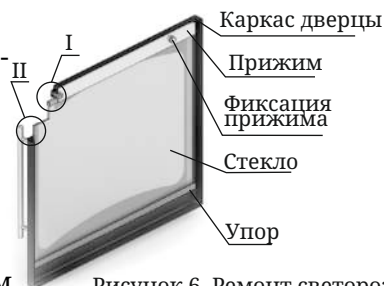
Рисунок 6. Ремонт светорозрачного экрана дверцы модификации «Люмина»
