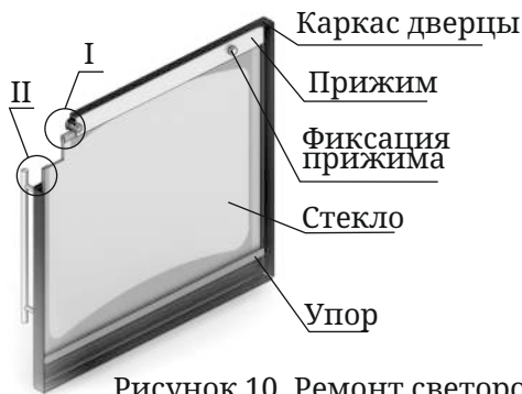
Рисунок 10. Ремонт светопрозрачного экрана дверцы модификации «Витра»
