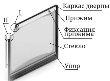
Рисунок 6. Ремонт светопрозрачного экрана дверцы модификации «Люмина»
