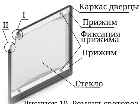
Рисунок 10. Ремонт светопрозрачного экрана дверцы.
