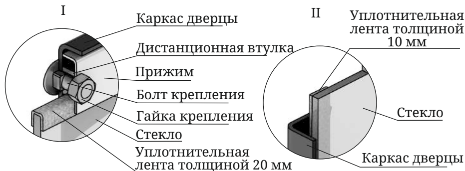
Рисунок 11. Крепление светопрозрачного экрана (стекла) дверцы.
