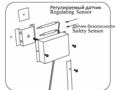
Рис.9 | Расположение датчика Fig. 9 | Sensor Location
