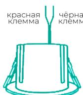
Подключите черную клемму динамика к отрицательному (-) выходу устройства воспроизведения.
