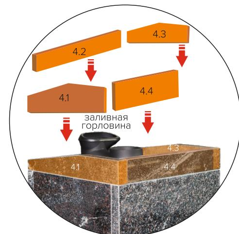
6. Четвертый ряд. Под заливную горловину устанавливаем самую узкую деталь (4.2), на противоположенную сторону самую высокую (4.4), а между ними располагаем элементы (4.1) и (4.3).
