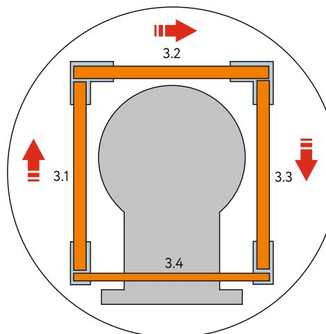
5. Третий ряд отличается от первого и второго только заменой узких элементов на целую плиту под номером 3.4. Устанавливаем скобы сверху.
