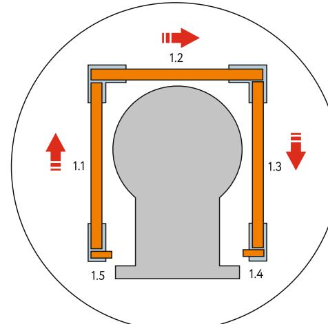
2. Далее собираем печь слева на право, если смотреть со стороны портала. Ставим плиту под номером 1.1 на установленные ножки, потом 1.2 и 1.3, вставляем узкие элементы у портала 1.4 и 1.5
