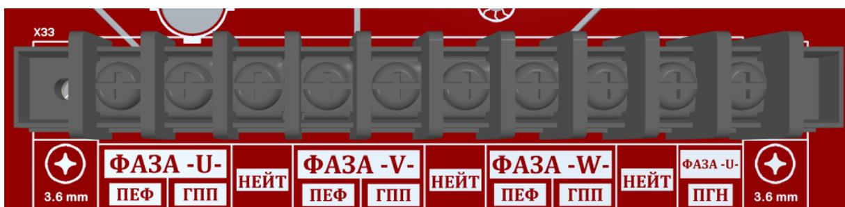
б) Подключение внешней силовой нагрузки
