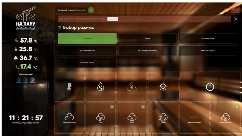
**На Пару Pro1-3** это целая система с огромным количеством возможностей и дополнительных функций для управления разными видами бань и саун в сухом и влажном режиме. Веб интерфейс системы позволяет управлять через любое устройство, имеющее выход в интернет.
