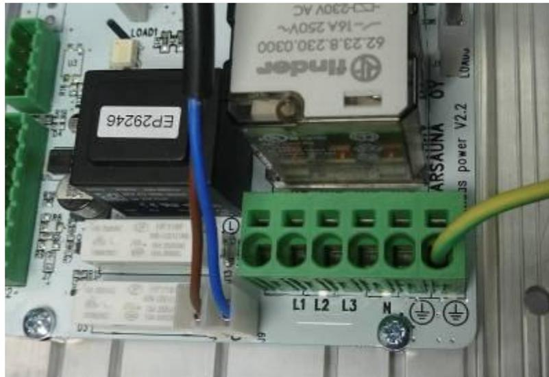
5. **Падение температуры (Соединитель J5)** (Если функция используется, к выходу можно подключать реле или катушку контактора, которое управляет нагреванием строения). Отсоедините соединитель от монтажной платы и прикрутите провода к соединителю. После этого вдавите соединитель обратно в монтажную плату. Винты при вдавливании соединителя должны смотреть вправо.
