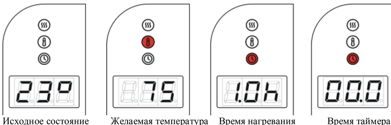
Разделы меню с регулируемыми параметрами выглядят, как показано на рисунке выше. Из одного раздела в другой можно перейти с помощью кнопки МЕНЮ. Если печь включена, то, как показано на рисунке выше, параметры можно регулировать с помощью кнопок (+) и (-).
