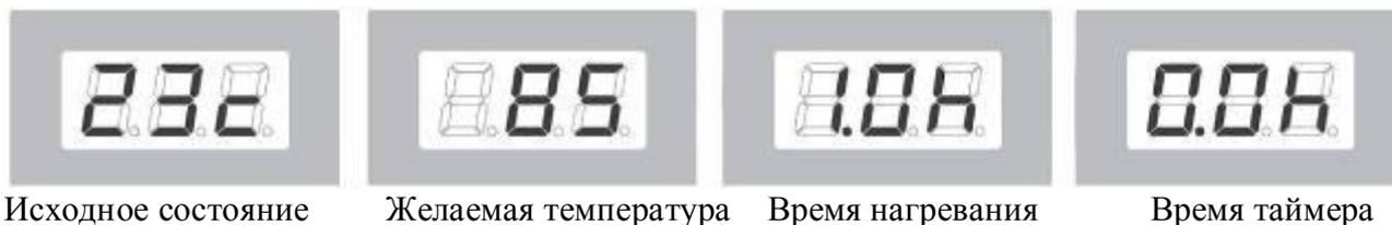
Разделы меню с регулируемыми параметрами выглядят, как показано на рисунке выше. Из одного раздела в другой можно перейти с помощью кнопки МЕНЮ. Если печь включена, то, как показано на рисунке выше, параметры можно регулировать с помощью кнопок (^) и (v).
