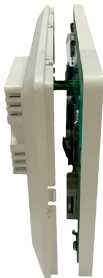
Рис. 23.: Шаг 2. Разъединение панелей дисплея
