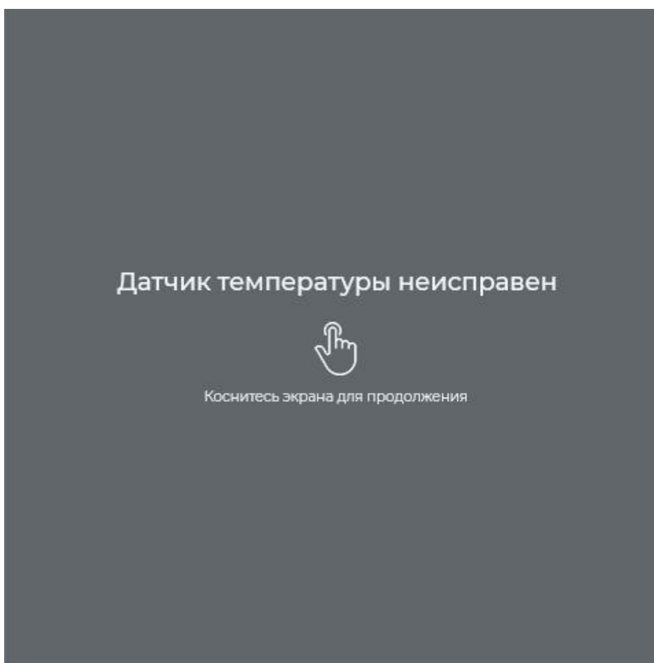
Рис. 41. Ошибка неисправности датчика температуры.
