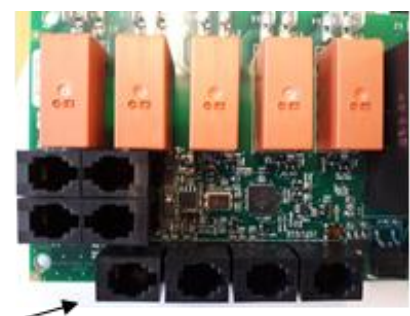
Figura 8 Orden de los conectores RJ 10. Sensor, interruptor de puerta, control remoto, NTC adicional
