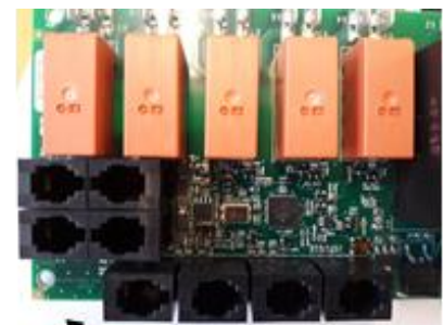
Рис 8 Расположение разъемов RJ 10. Датчик, дверной выключатель, дистанционное управление, дополнительный датчик NTC
