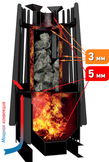
Рис. 3 Устройство и работа печи
