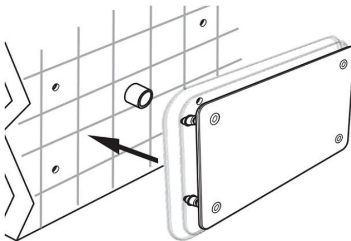
4. Закрепите винты шестигранным ключом на 3 мм.
