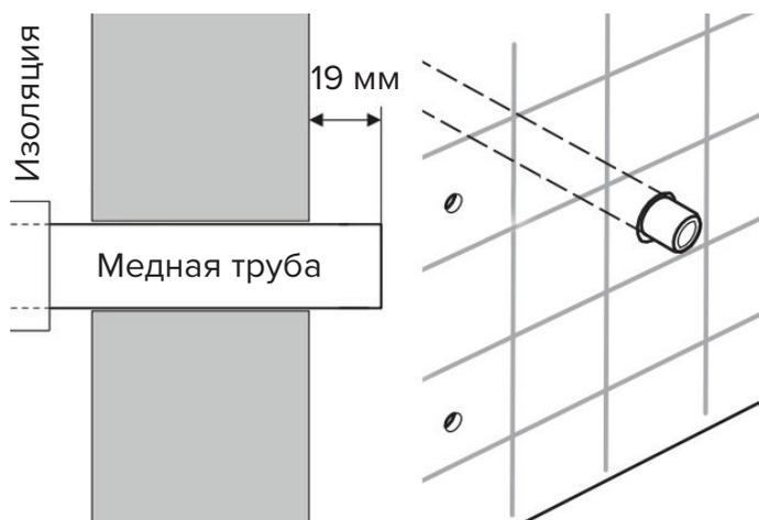
3. Разместите форсунку так, чтобы медная труба паропровода помещалась в отверстие в задней части форсунки, а резиновые «ножки» в соответствующие отверстия.
