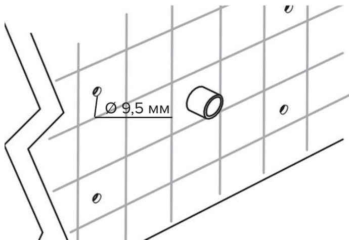
2. Выведите медную трубу паропровода из стены на 19 мм, проделав в стене соответствующее отверстие. Паропровод от парогенератора к форсунке должен идти под небольшим углом вниз, во избежание образования конденсата. Максимальный диаметр паропровода 32 мм для форсунки DN25 и 40 мм для форсунки DN40.
