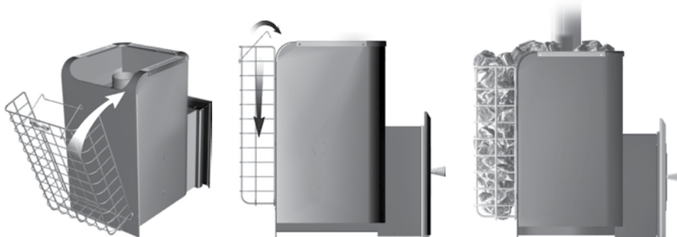
Рисунок -10. Установка сетки-каменки на печь.
