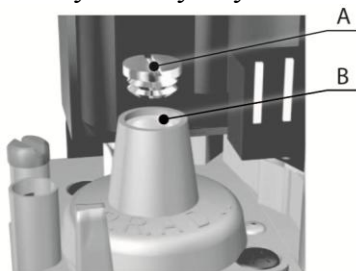
А – заглушка; В – регулировочный винт. Рисунок – 6. Регулировка выходного давления
