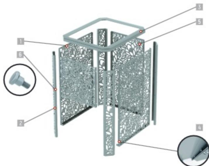
Рис. 4 Схема сборки защитного кожуха
