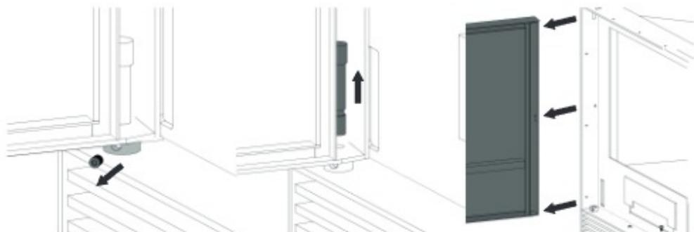
1 Выкрутите фиксирующий винт из опорной втулки
