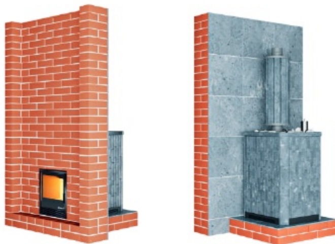
Рис. 5 Проход топочного канала
