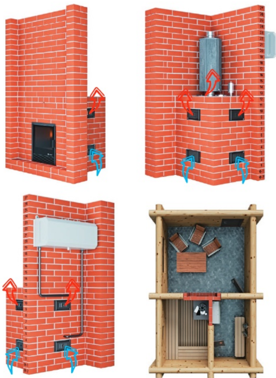
Рис. 10 Пример установки печи в кирпичном кожухе с функцией обогрева комнаты отдыха и моечного отделения
