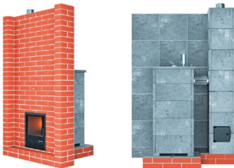
Рис. 9 Пример установки печи с отдельно стоящим дымоходом
