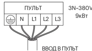
Если соединительный или монтажный кабель подходят к сауне, или сквозь стены сауны, на высоте более 500 мм, они должны выдерживать при полной нагрузке температуру 170 °C. Приборы, устанавливаемые на высоте более 500 мм от уровня пола сауны, должны быть пригодными для использования при температуре 125 °C (маркировка T125).
