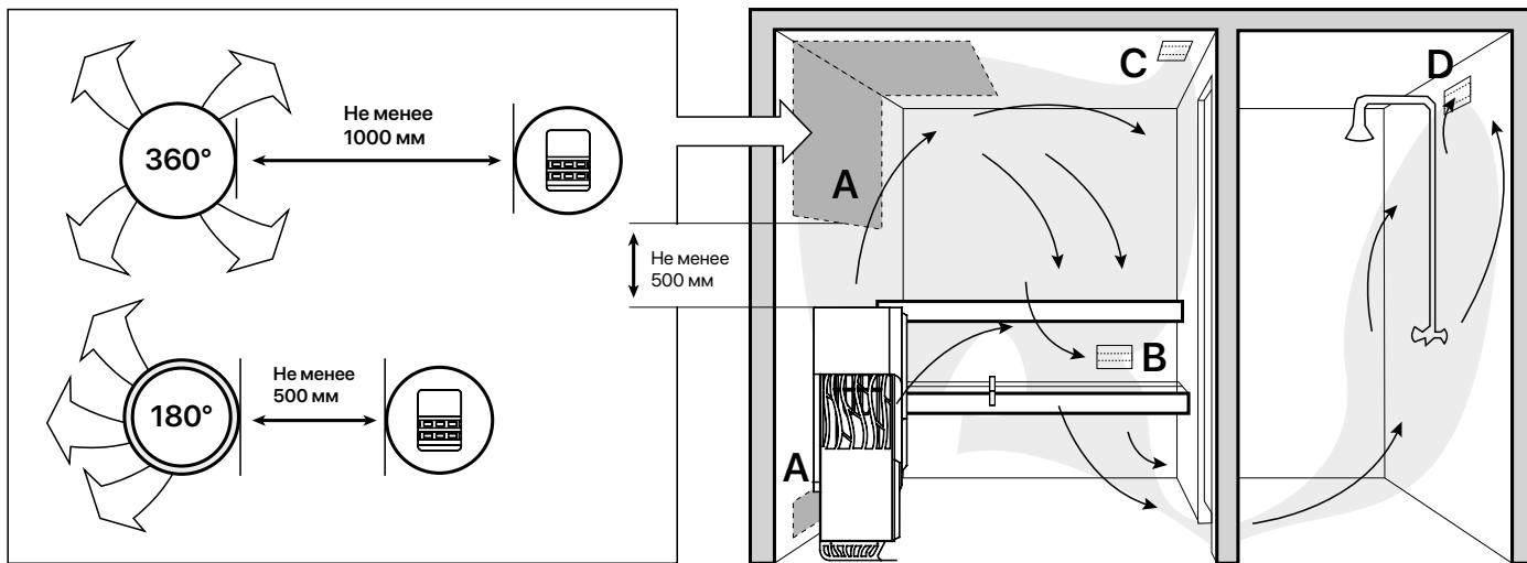
A. Размещение приточного вентиляционного отверстия. Если используется механическая вентиляция, поместите вентиляционное отверстие над каменкой. Если вентиляция естественная, поместите вентиляционное отверстие под или рядом с каменкой. Диаметр трубы для притока воздуха должен быть 50-100 мм. **Вентиляционное окно не должно охлаждать температурный датчик (см. инструкции по установке температурного датчика в руководстве по установке пульта управления)!**
