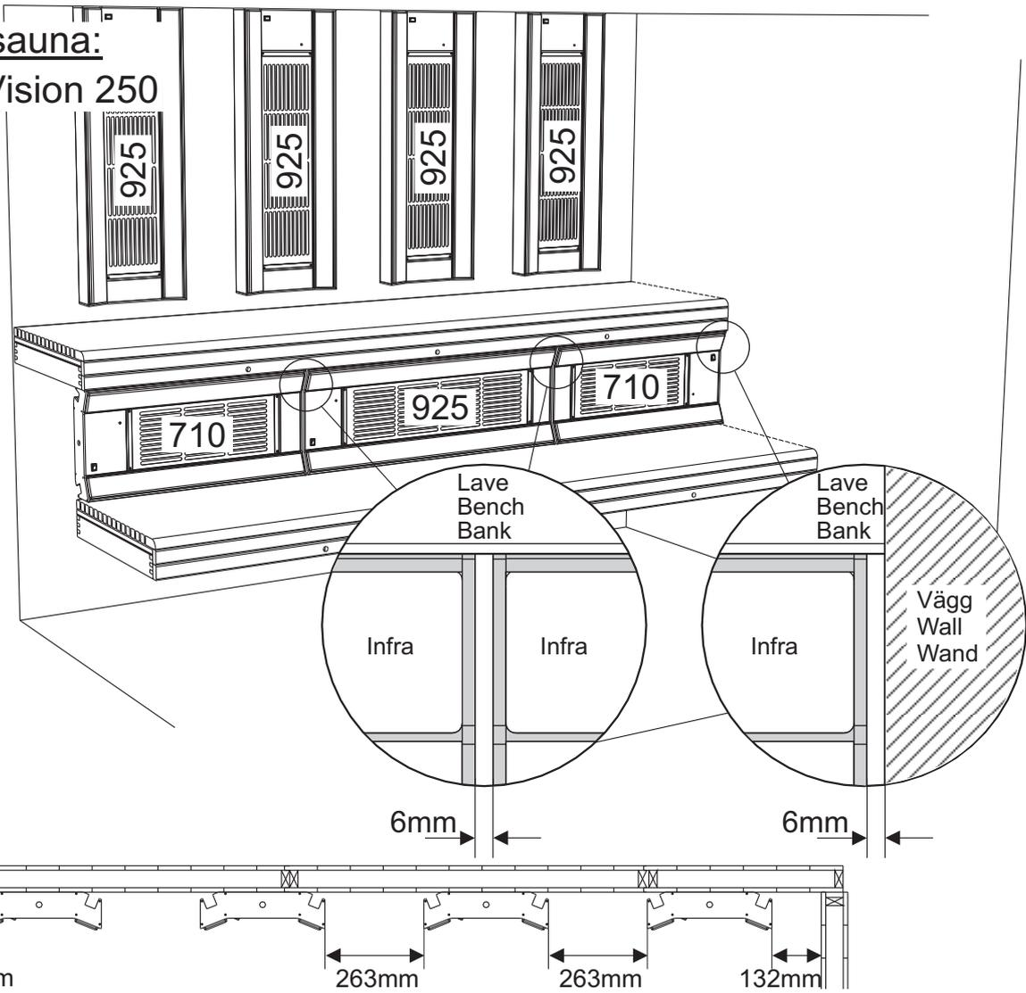
Montering av lavar / Assembling the benches / Bankmontage / Montage des banquettes
