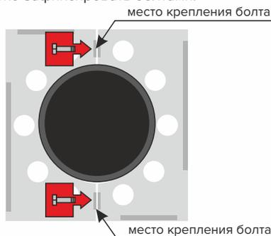
2. Задвинуть первую каменную панель в соответствии со схемой, так чтобы в паз на панели вошла скоба (направляющая) №1 на нижней монтажной площадке
