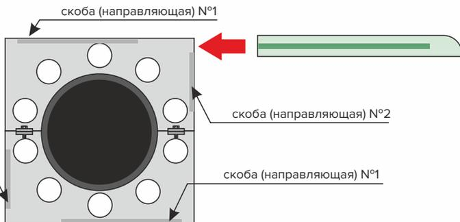
3. а) установить верхние монтажные площадки поверх каменной панели, поместив скобу монтажной площадки в паз на каменной панели. б) наживить болты, без сильной фиксации.
