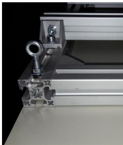
Наденьте поддон для сбора конденсата снизу на алюминиевую раму снегогенератора. Если снегогенератор подвешивается к потолку на шпильках, то прикрепите поддон к раме с четырех сторон саморезами.
