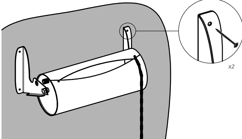
Примечание: выше описан порядок сборки и установки обливного устройства на стену. Процесс установки на потолок аналогичен, за исключением того, что ось корпуса А устанавливается в отверстия у основания кронштейнов F.
