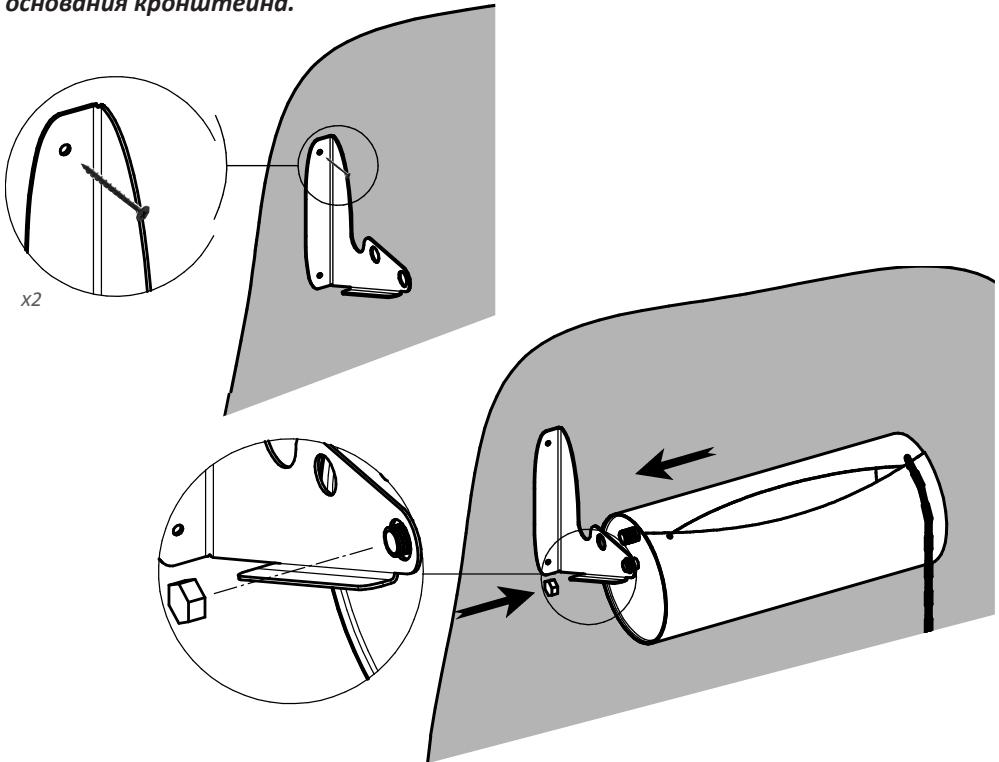
3) Вставьте ось на противоположной стороне корпуса **A** в отверстие на втором кронштейне **F**. Накрутите гайку-фиксатор **B** на ось устройства. Закрепите кронштейн **F** на стене.
