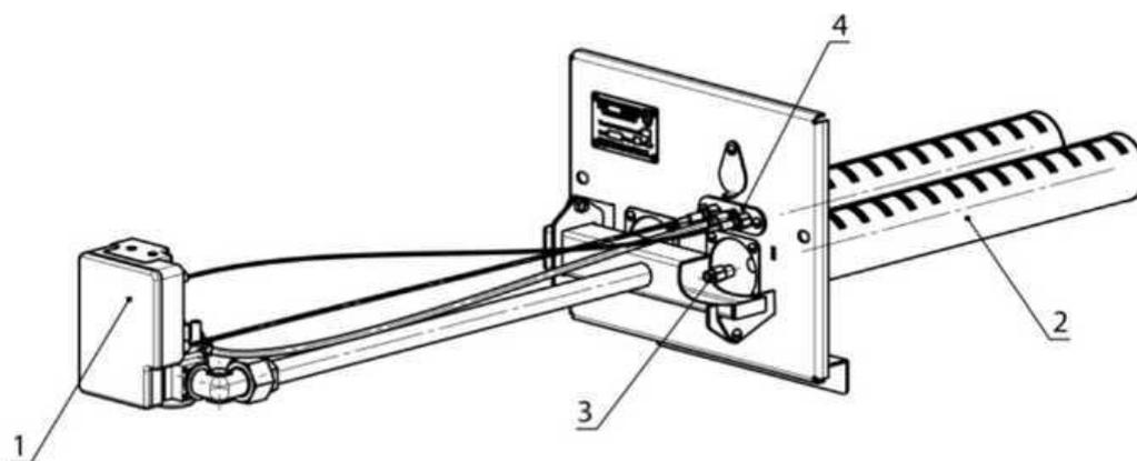
1 - регулятор подачи газа SIGMA-840, 2 - газовый рожок из нержавеющей стали, 3 - сопло, 4 - запальник.
