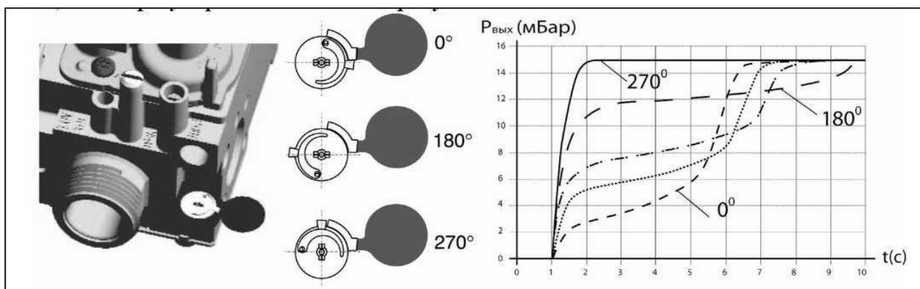
Регулировка плавности открытия осуществляется поворотом регулировочного винта, схема регулировки показана на рисунке 7.
