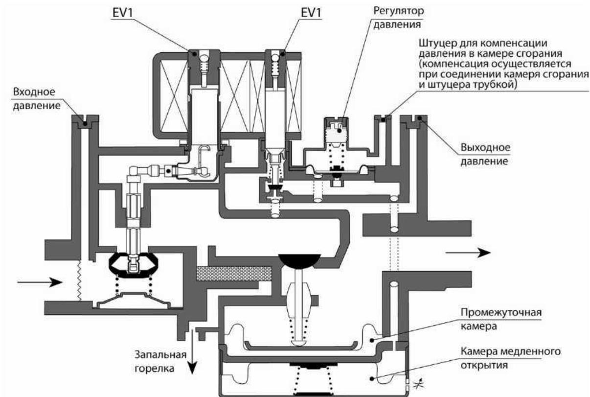
EV1 - катушка первого клапана, EV2 - катушка второго клапана.
